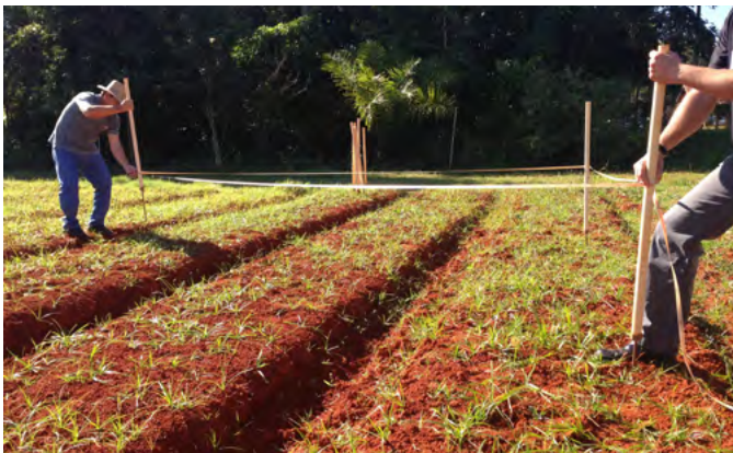
Movimentação do piquete para obter a sobreposição do nº 12 ao nº 0.
