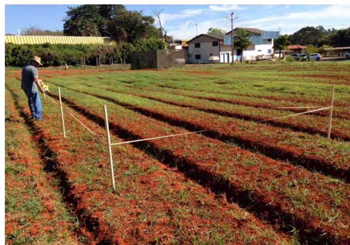
Alinhamento da trena a um dos menores lados do triângulo.
