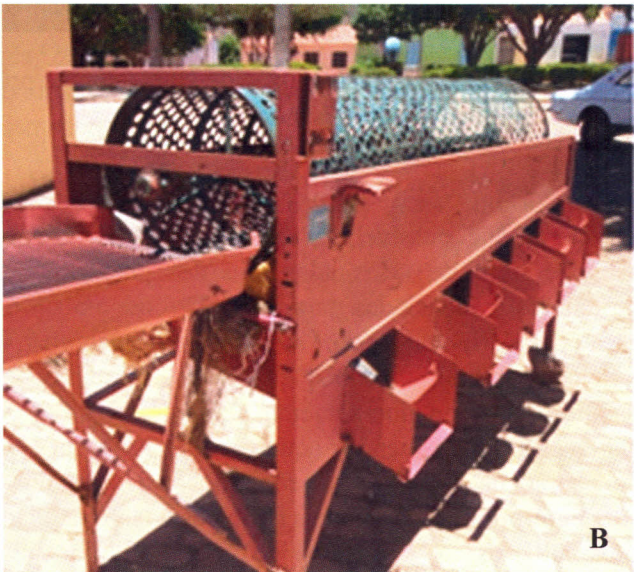
Figura 6. Jogo de peneiras para classificação dos bulbilhos (A) e classificador mecânico para separação dos bulbos por tamanho (B). (Fotos: Francisco Vilela Resende (A); José Luis Pereira (B))
