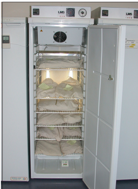
Acima: Incubadora refrigerada com sementes em sacos de tecido.
