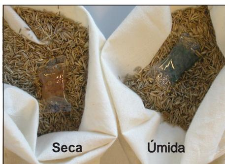
Acima: Sachês de sílica gel indicadora com metil violeta em amostras seca e úmida.
