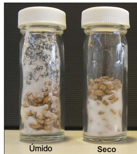
Acima: Avaliação de amostras secas e úmidas usando o teste do sal.
