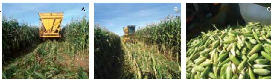
Figura 1. Máquina de colheita mecânica (A e B) de milho-doce e detalhe do depósito de espigas (C).
