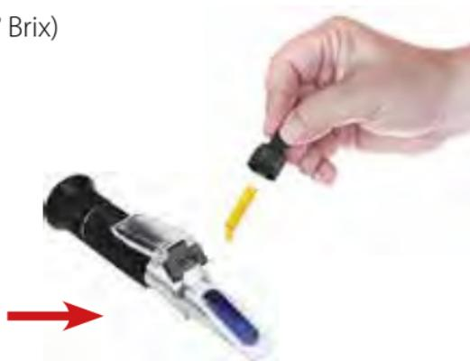
Colocar duas gotas da polpa no refratômetro
