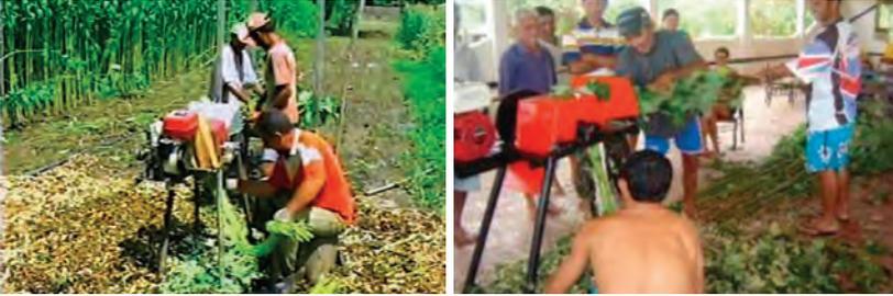
Protótipo Arraia aperfeiçoado a partir do modelo utilizado para o rami por técnicos da Sagri e da Ufra. Na direita, modelo desenvolvido pela Ufam que até o momento teve o melhor desempenho no campo.
