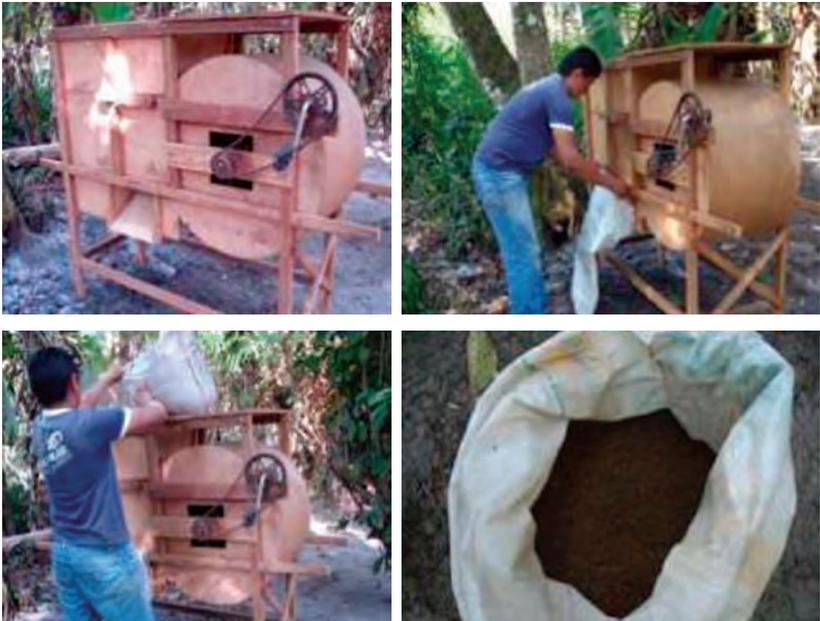
Máquina (ventiladora artesanal) do processo mecanizado de separação do carrapicho.
