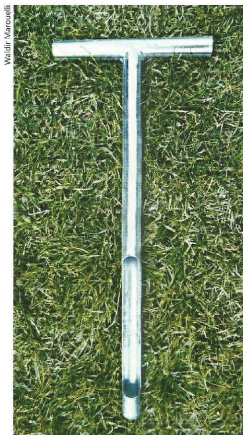
Trados tipo meia-cana para a amostragem e avaliação da disponibilidade de água no solo
