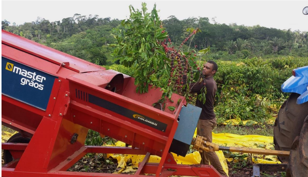
Figura 5. Trilhadora de café durante ensaio de campo. Na imagem pode-se ver a trilha de partes do cafeeiro provenientes da simulação de uma situação de poda drástica. Esta máquina não possui plataforma de recolhimento e necessita ser alimentada manualmente.
