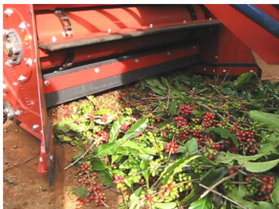
Figura 4. Os ramos provenientes das podas, contendo os frutos, formam leiras que são recolhidos pela plataforma e trilhados mecanicamente.
