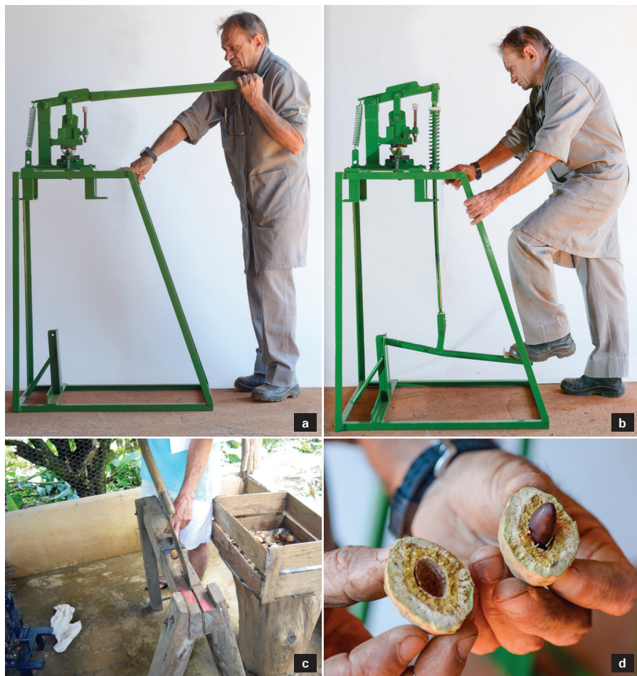
Figura 3. (a) Quebrador manual de baru; (b) quebrador de baru acionado por pedal; (c) quebrador tradicionalmente utilizado com foice; (d) fruto quebrado com amêndoa inteira extraída.
