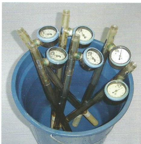
Saturação de tensiômetros em recipiente com água
