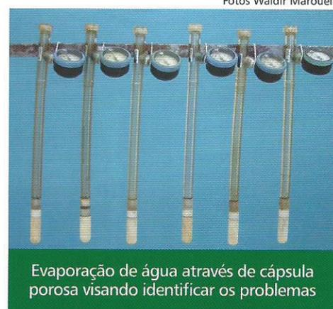
Evaporação de água através de cápsula porosa visando identificar os problemas
