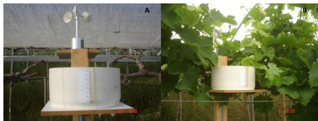
FIGURA 3. Mini-tanque evaporimétrico “SM” (COSTA, 2004), com piezômetro em detalhe instalado no estádio fenológico 00, gemas latentes segundo Lorenz et al., 1995, sob cultivo protegido (A). Mini-tanque “SM” instalado ao nível do dossel vegetativo no estádio fenológico 19 (B). Bento Gonçalves, RS, 2011.
