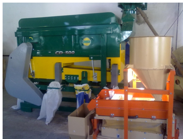
Figura 13 – Máquina de ar, e peneiras e mesa de gravidade utilizadas no beneficiamento de sementes de cornichão e trevo-vermelho, realizado na Embrapa Produtos e Mercado (Capão do Leão/RS).
