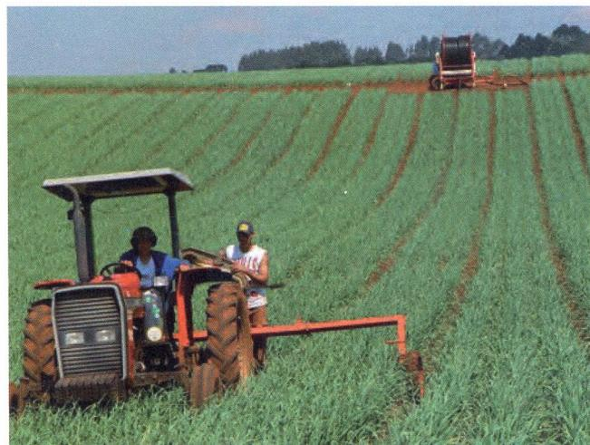
Figura 8. Carretel enrolador (ao fundo) de sistema de irrigação por aspersão tipo autopropelido.
