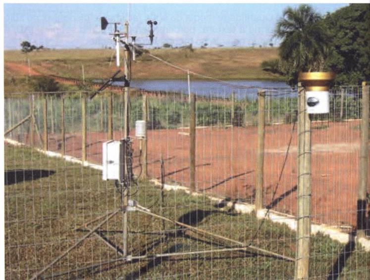
**Figura 16.** Estação agrometeorológica para medição das variáveis climáticas necessárias para a determinação da evapotranspiração de referência (ET<sub>0</sub>) pelo método de Penman-Monteith-FAO.
