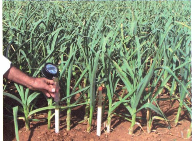
**Figura 14.** Tensiômetros instalados em duas profundidades para medição da tensão de água no solo com o uso de tensiômetro digital.
