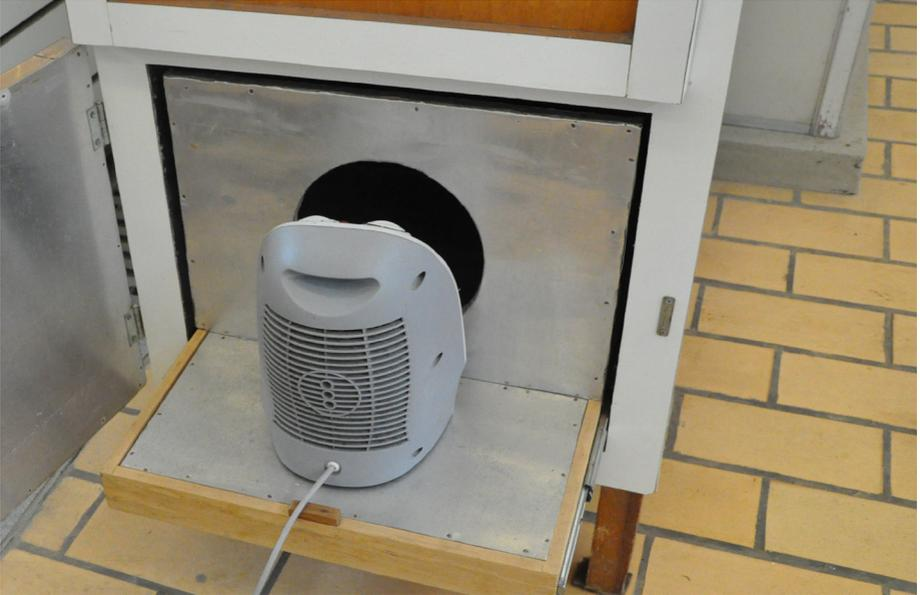
**Figura 8.** Posição da bandeja do sistema de aquecimento e ventilação.
