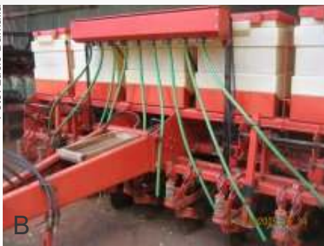
Figura 4. Caixas exclusivas para linhas intercalares de milho e braquiária (A); caixa adicional (terceira caixa), exclusiva para sementes de forrageira, e condutores individuais para cada linha de sementes posicionada próxima da linha de milho (B).
