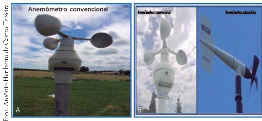
Figura 9. Sensores de velocidade do vento para estações agrometeorológicas (A) convencionais e (B) automáticas.
