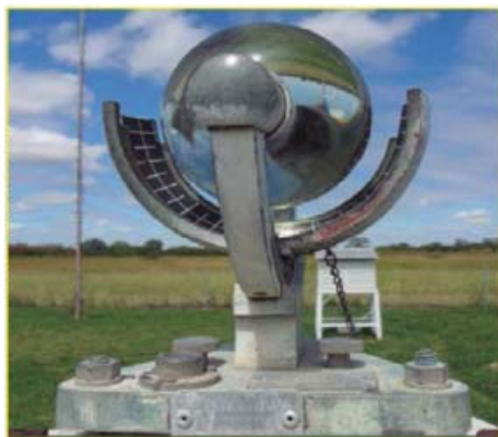
Figura 2. Instrumento para medição da insolação em estações agrometeorológicas convencionais (Heliógrafo Campbel-Stokes).
