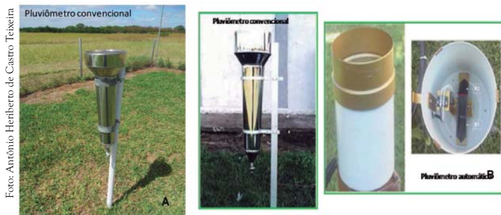
Figura 14. Instrumentos de precipitação para estações agrometeorológicas convencionais (A) e automáticas (B).
