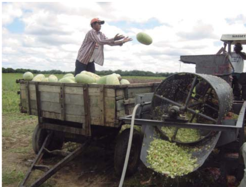
Figura 10. Extração mecânica de sementes de melancia, Petrolina, PE.
