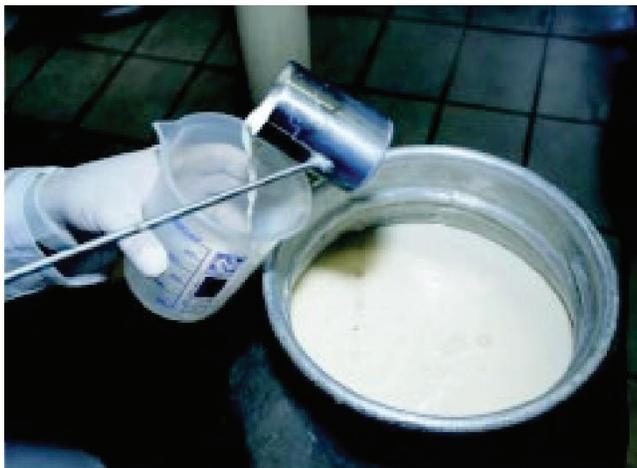
**Figura 6.** Transferência do volume de leite amostrado do latão para recipiente por meio de coletador de aço inox.
