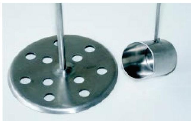
**Figura 4b.** Detalhe do homogeneizador e do coletador de amostras.
