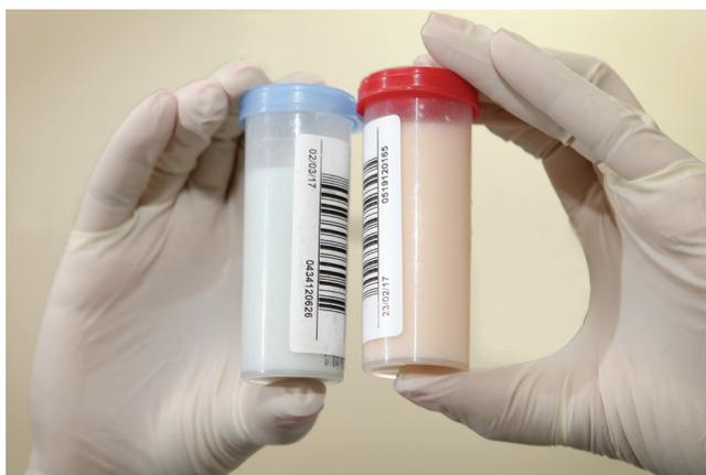
**Figura 3.** Amostras de leite com coloração azulada (esquerda) e de pêssego (direita) após adição do conservante azidiol e Bronopol®, respectivamente.
