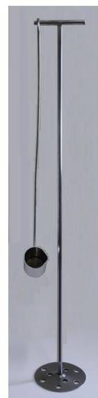
**Figura 4a.** Homogeneizador (direita) e coletador de aço inoxidável (esquerda), utilizados para coleta de amostras de leite em latões.
