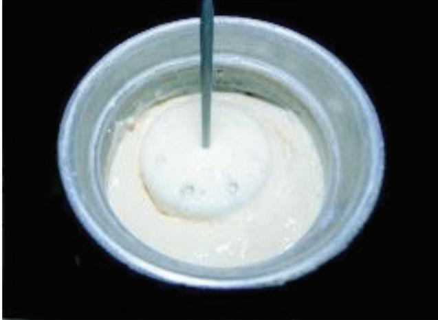
**Figura 5.** Processo de homogeneização (movimentos suaves para cima e para baixo), para coleta de amostra de leite em latões.
