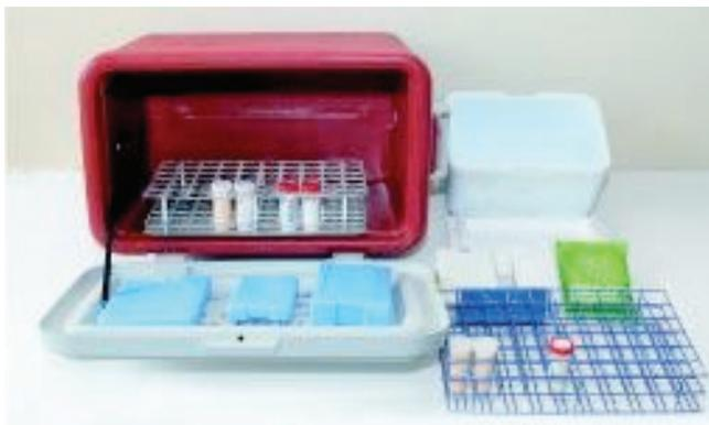
**Figura 2.** Caixas isotérmicas (plástico e isopor), gelos recicláveis e estantes para armazenamento e transporte de amostras de leite.
