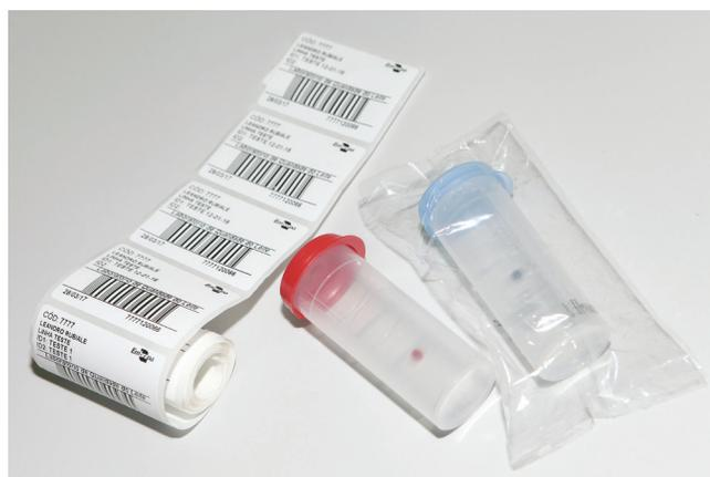
**Figura 1.** Frasco com tampa de pressão vermelha com pastilha de Bronopol® no interior utilizado para coleta de amostras destinadas à determinação dos componentes e contagem de células somáticas em amostras de leite cru (direita). Frasco estéril com tampa de pressão azul no interior pastilha de azidiol utilizado para coleta de amostras de leite para a contagem total de bactérias (CTB).
