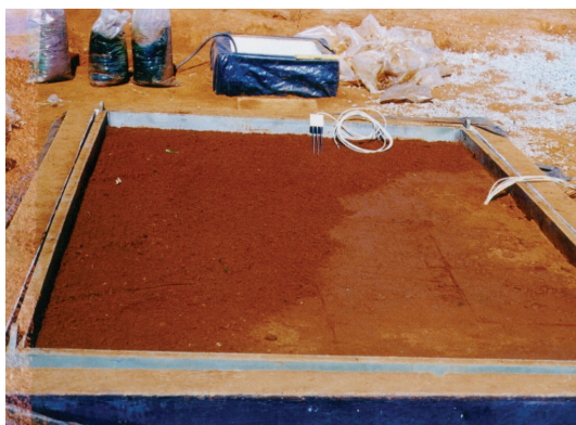
Figura 3. Vista do lisímetro de pesagens com dimensões de 2,0 m de largura por 3,0 m de comprimento e 1,2 m de altura, instalado no interior da área irrigada na Embrapa Cerrados.
