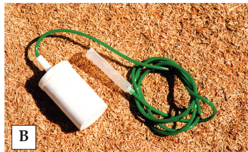
Figura 20. Profundidades de instalação do Irrigas® (A) e o equipamento construído artesanalmente (B).
