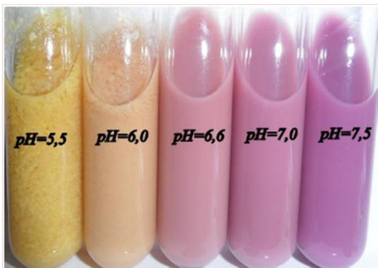
Figura 1. Tubos de ensaio com amostras de leite após o teste do alizarol. Amostras com pH 5,5 e 6,0: leite ácido; amostra com pH 6,6: leite normal; amostra com pH 7,0 e 7,5: leite alcalino (SANTOS SILVA, 2013).
