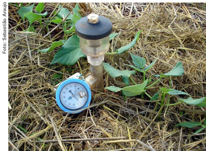
**Figura 10.** Tensiômetro.
