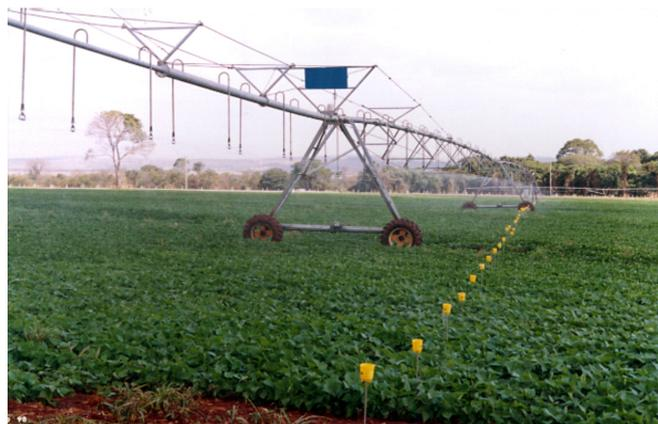
Figura 1. Teste de aplicação de água em campo.
