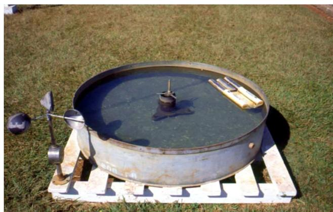
**Figura 9.** Tanque Classe A.
