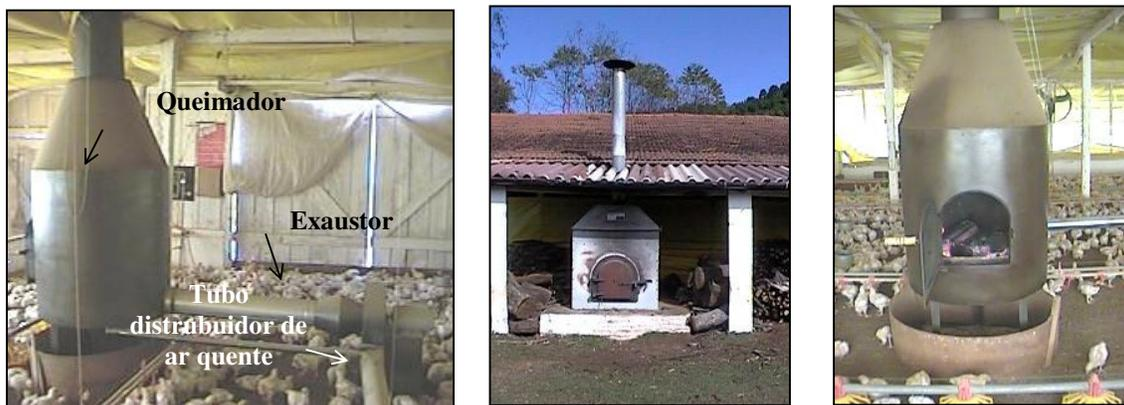
**Fig. 3** – Novos sistemas de aquecimento a lenha.
