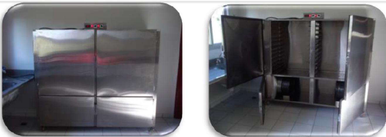
Fig. 10. Secador de cabine desenvolvido para secagem de uva.
