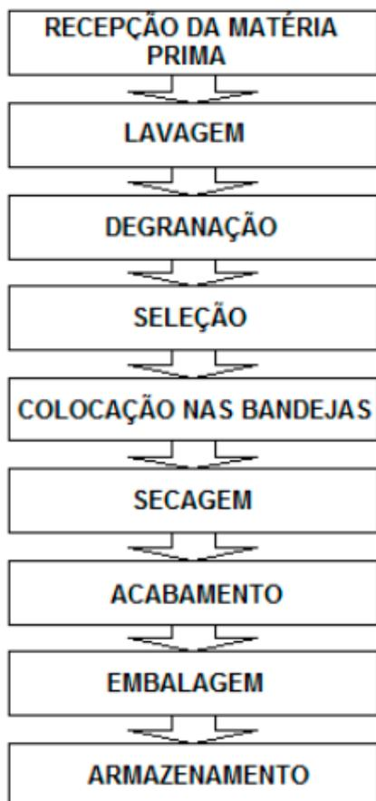
Fig. 12. Fluxograma de processamento para obtenção de uva-passa.
