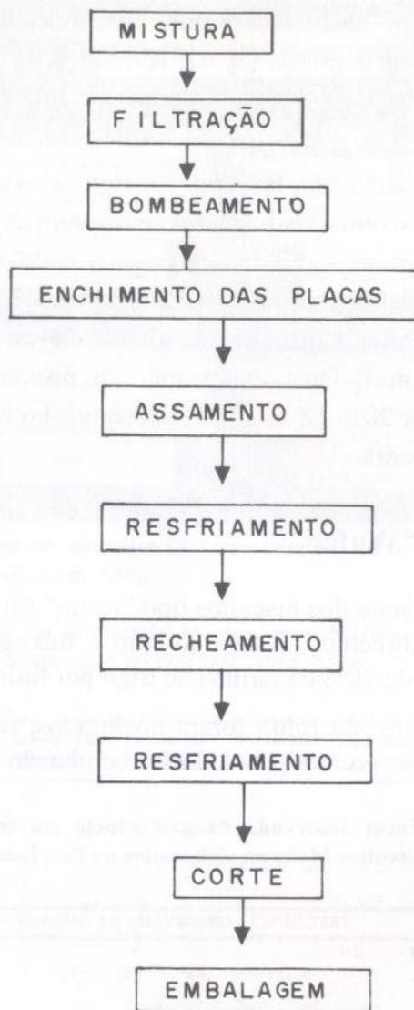
FIG. 8. Fluxograma para produção de biscoito "wafer" na Cia. Campineira de Alimentos.
