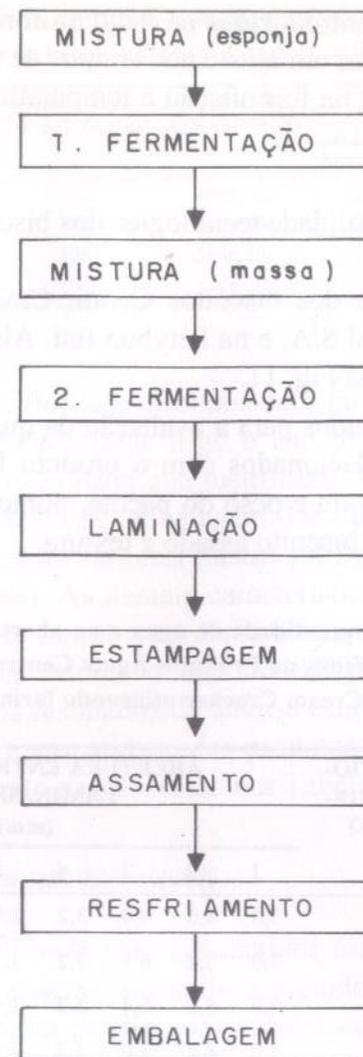
FIG. 10. Fluxograma de produção de biscoito Cream Cracker.
