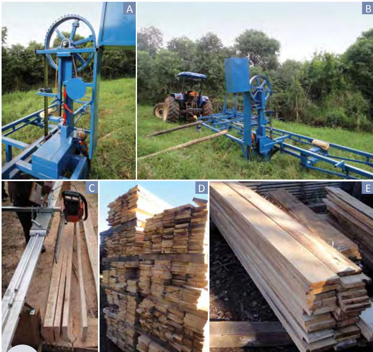
Figura 2. Exemplo de serraria móvel (a, b, c) e madeira serrada (d, e).
