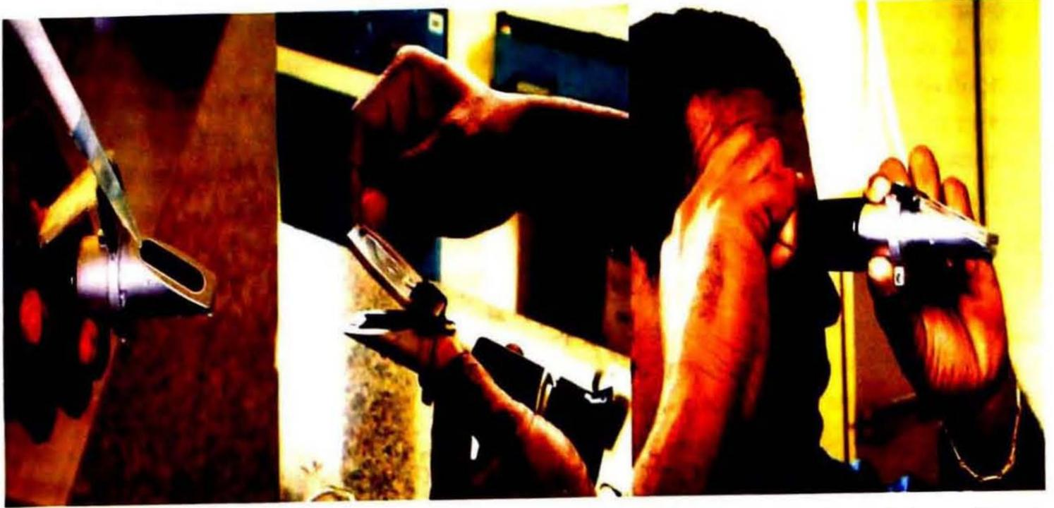
Fig. 2. Uso de refratômetro manual para a determinação do teor de sólidos solúveis totais no suco do fruto. Colocação de gotas da amostra de suco sobre o prisma (esquerda), dobrando a tampa sobre o prisma com o suco (centro) e fazendo a leitura contra a luz (direita).
