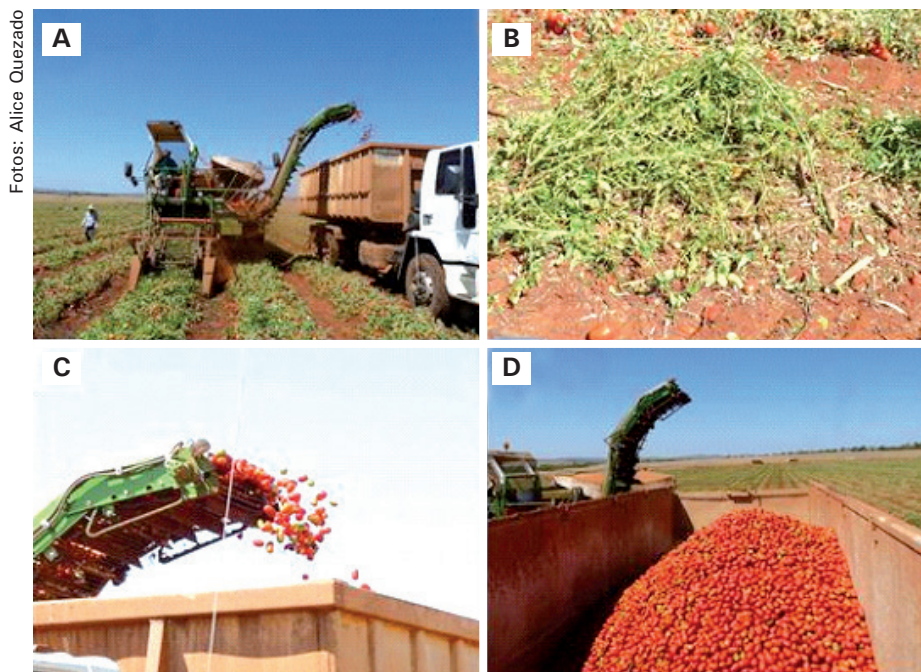
Figura 9. Primeira colheita mecanizada de BRS Sena em área de produtor, Caldas Novas, GO, 2010. A. Conjunto colhedora-caminhão caçamba. B. Ramas de plantas de BRS Sena liberadas pela colhedora. C. Carregamento da caçamba. D. Frutos colhidos.
