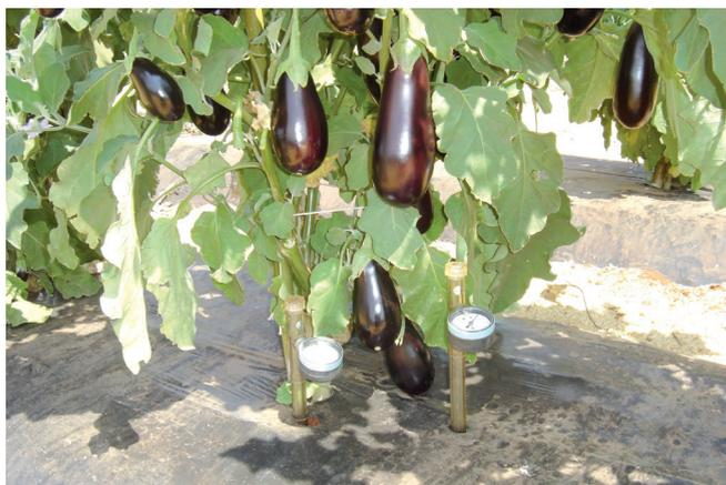
**Figura 10.** Tensiômetros, com vacuômetros metálico tipo Bourdon, instalados em lavoura de berinjela para avaliação da tensão de água no solo.
