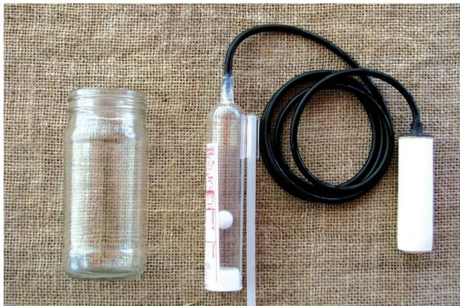
**Figura 11.** Sensor do tipo Irrigas® para avaliação da tensão de água no solo, incluindo cuba e frasco transparente de leitura.
