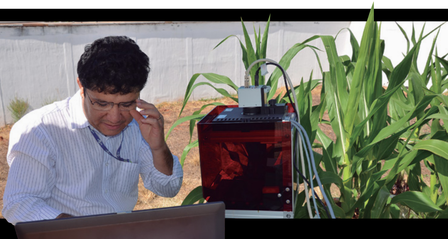
Equipamento permite verificar quanto de luz está sendo absorvido pela planta e quanto é usado para a fotossíntese
