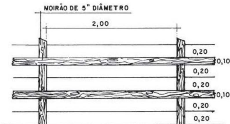
FIG.13. Modelo de cerca não-eletrificada mista de arame liso e madeira.
