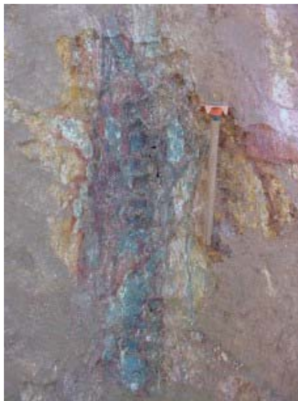
Figura 14. Detalhe de um veio de composição mais argilosa e coloração cinza representando rochas alteradas do Complexo Cristalino.
