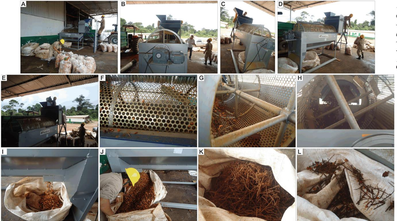
Figura 2. Sequência de imagens dos testes com o primeiro protótipo de desracemador mostrando: vista geral do equipamento com os preparativos para os testes (A, B, C, D, E), detalhes do cilindro/batedor com peneiras (F, G, H), frutos livres dos racemos (I, J) e racemos separados (K, L).
