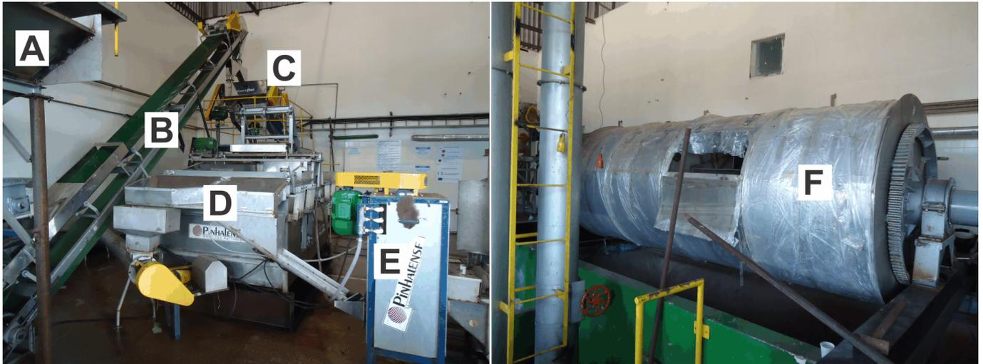
**Figura 8.** Vista geral da usina de processamento pós-colheita de guaraná instalada na Jayoro - A: moega de recepção; B: transportador; C: despoldador; D: lavador/separador; E: desarilador e, F: secador rotativo. Todos os equipamentos confeccionados em aço inoxidável.
