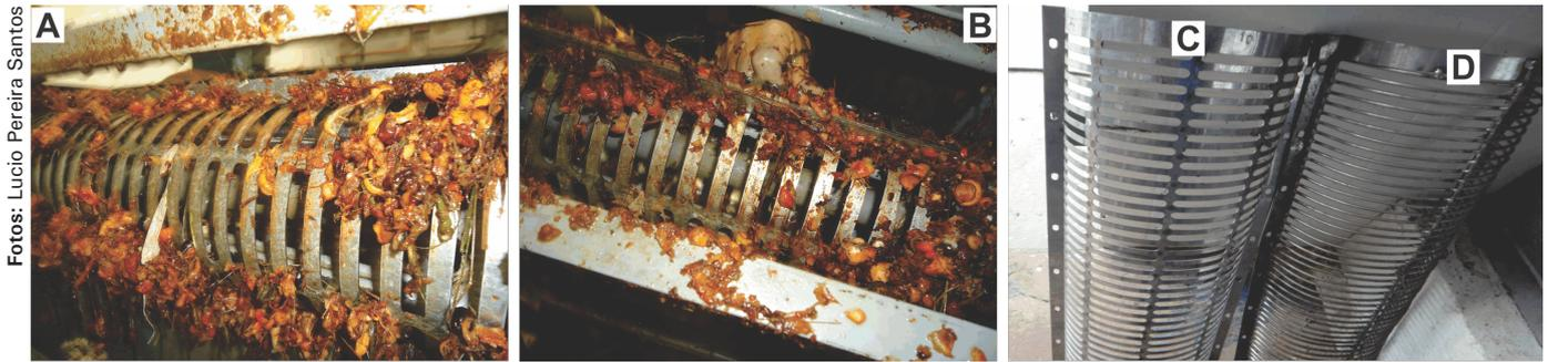
**Figura 4.** Despolpamento do guaraná com a peneira original do Econoflex (A, B) e comparação da original (C) com a peneira que foi desenvolvida para guaraná (D), ambas confeccionadas em aço inoxidável.
