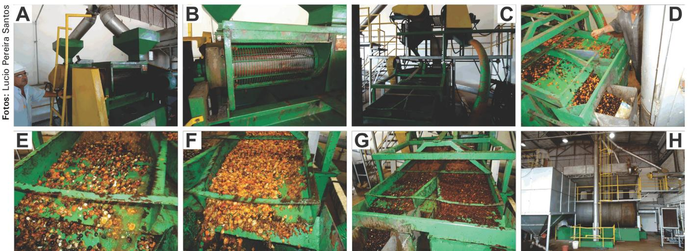
Figura 1. Vista do maquinário antigo da Jayoro, constituído de despulpador (A, B), lavador/separador (C, D, E, F, G) e secador rotativo (H).
