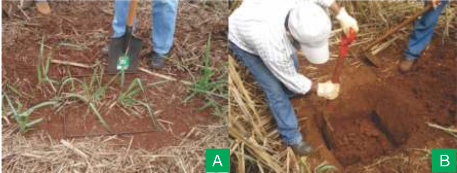
Figura 1. Quadrado de ferro utilizado para estabelecer as dimensões da trincheira (A); trincheira aberta no solo (B).
