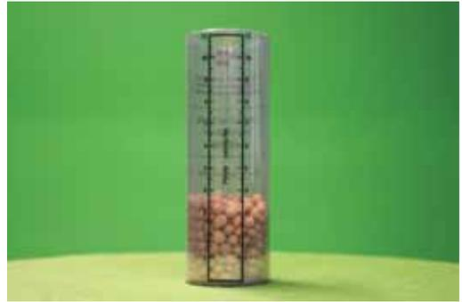
**Figura 3.** Determinação do nível de perda (1 saco de 60 kg/ha) e da quantidade desperdiçada (aproximadamente 3 sacos) de grãos na colheita de soja, utilizando o método do copo medidor.
