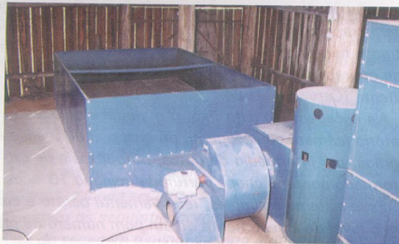
*Figura 5. Vista geral do secador de leito fixo.*
