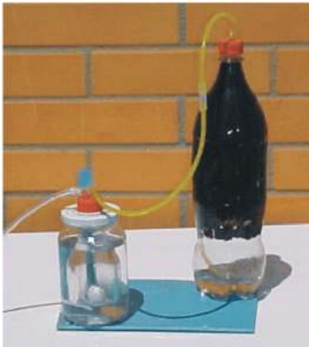
Figura 6.4- Foto de um sinalizador de irrigação pressurizado com auxílio de um compressor térmico simples.
