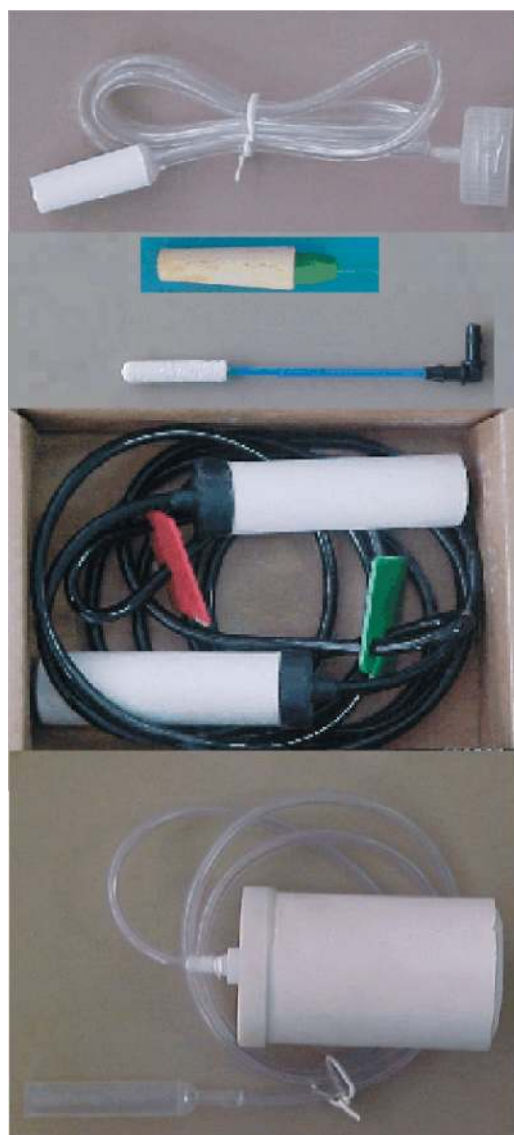
Figura 17.1- Alguns sensores tipos de sensores Irrigas. No topo, dois sensores com cápsula miniatura para regadores automáticos, no meio um sensor mini para tubetes; e na base sensores Irrigas sem e com cuba para o teste de imersão para uso no campo.
