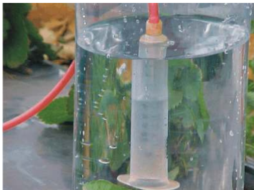
Figura 16.1- Em solo com tensão de água maior que a tensão crítica do sensor Irrigas, torna os poros deste sensor permeáveis ao ar e assim, em solo seco a água entra na cuba durante o teste de imersão, ao contrário do que ocorre quando o solo está úmido. O teste de imersão é uma forma de utilizar o sensor Irrigas para determinar o momento da irrigação.
