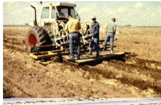
Figura 25. Detalhe da instalação de laterais de gotejamento subsúperficial (Foto de Richard Mead, USA).
