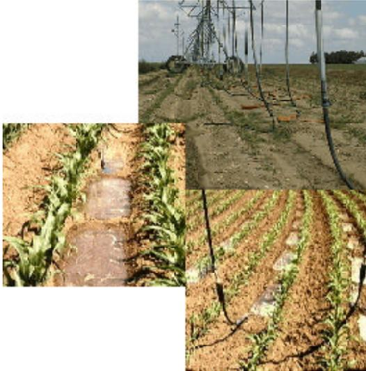
Figura 19. Pivô central dotado de LEPA (acima a direita) e detalhes dos sulcos com microdepressões (Fotos de Terry Howell, USDA).
