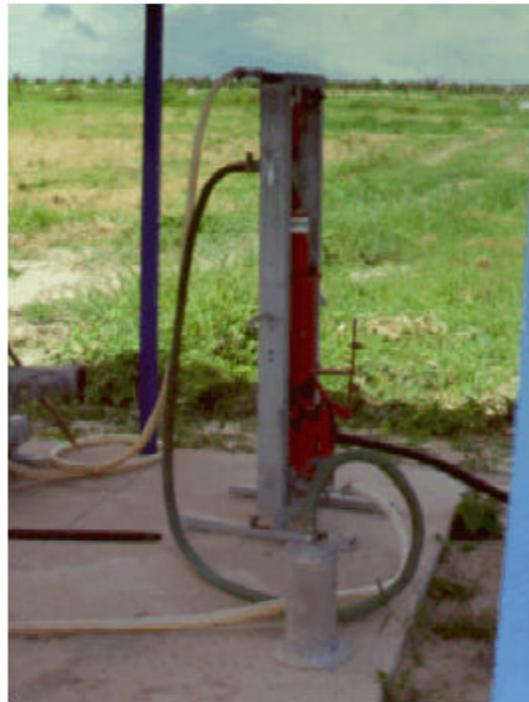
Figura 20. Bomba hidráulica para injeção de fertilizantes e defensivos na água de irrigação (Foto de Camilo L.T. Andrade).
