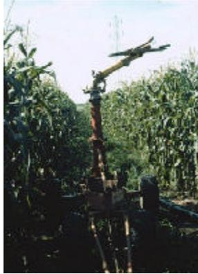
**Figura 14.** Sistema de aspersão portátil tipo montagem direta com canhão (Foto de Rabi H. Mohtar, Purdue University).
