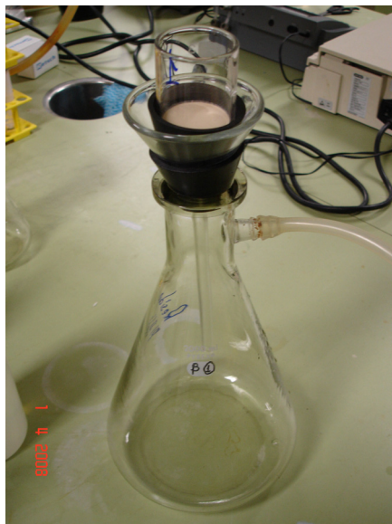
Fig. 1. Sistema de filtração à vácuo.
