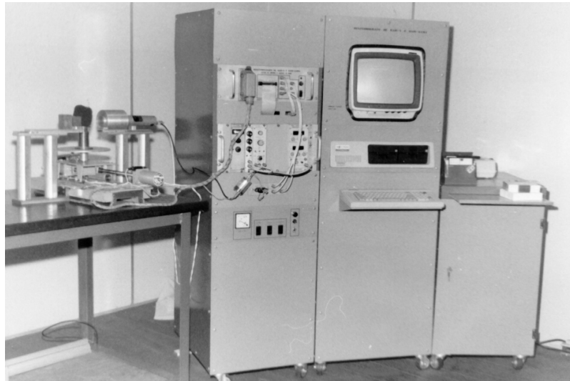
Figura 2. Tomógrafo de raios gama utilizado para obtenção das imagens tomográficas para E. saligna e P. elliotii .
