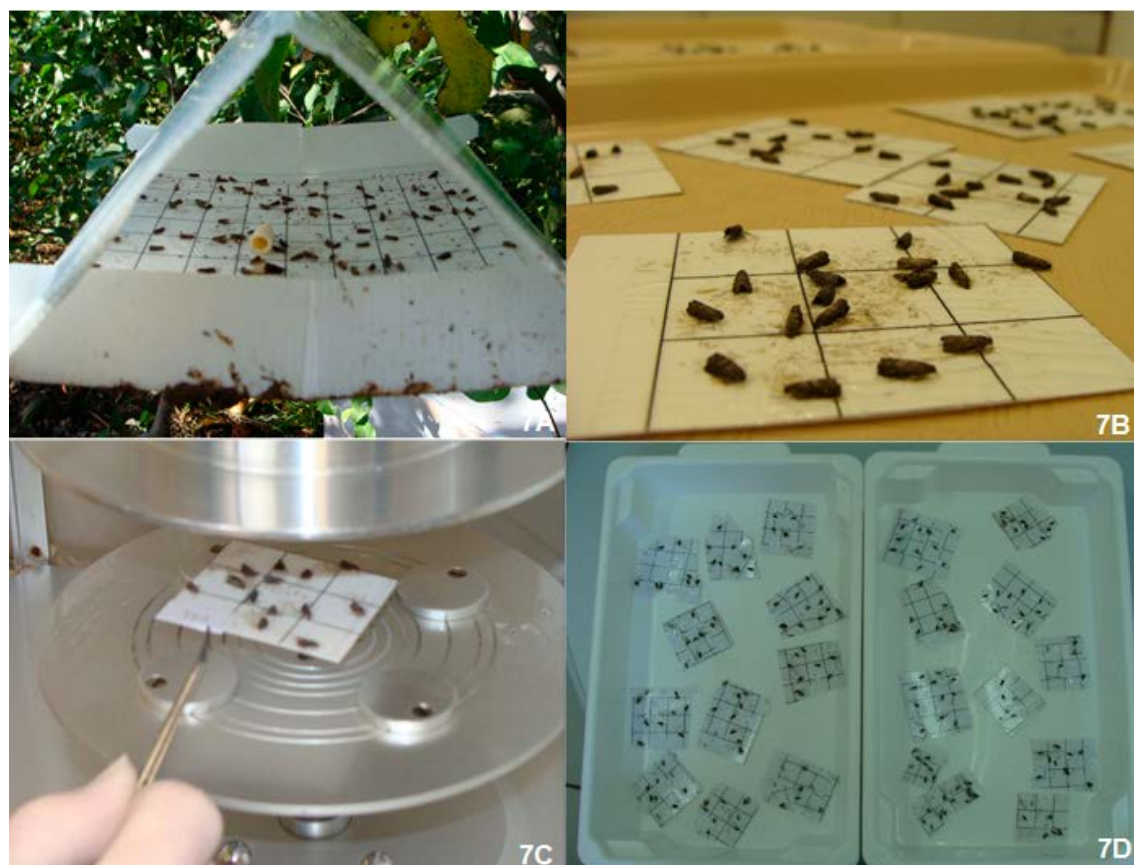
Fig. 7. Procedimentos para bioensaios com aplicação em torre de Potter. (A) Coleta de adultos machos com armadilhas de feromônio; (B) Piso de cola recordado e confeccionado em cartões com adultos machos; (C) Aplicação em torre de Potter e (D) Cartões após a aplicação dos inseticidas sobre adultos machos de G. molesta . Fotos: Oscar A. B. Neto-Silva.
