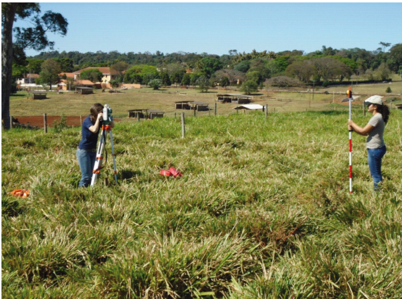
Figura 4. Posicionamento, através de Estação Total, do local de deposição de urina bovina, visualizado e marcado durante a noite através de lanterna de luz negra. Foto: Teresa Cristina Alves.
