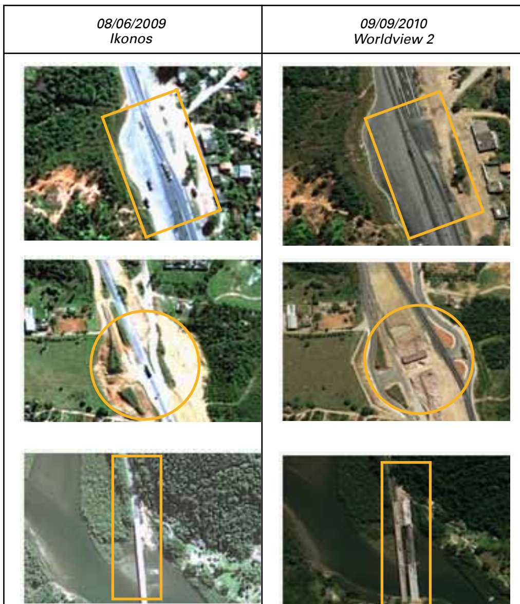
Figura 11 - BR 101 Trecho SC – Detalhe de alguns trechos da Obra (de cima para baixo): (a) Início do canteiro central e duplicação, (b) Implantação do trevo e (c) Duplicação de Ponte.
