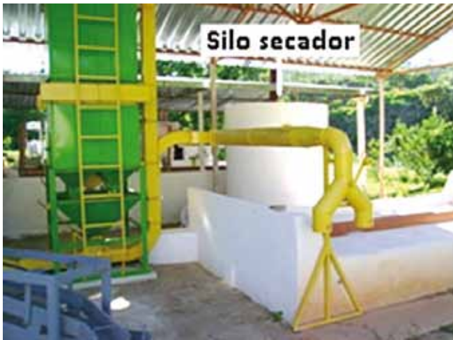
Figura 21. Sistema de secagem combinando pré-secador, secador pneumático e silo secador.
