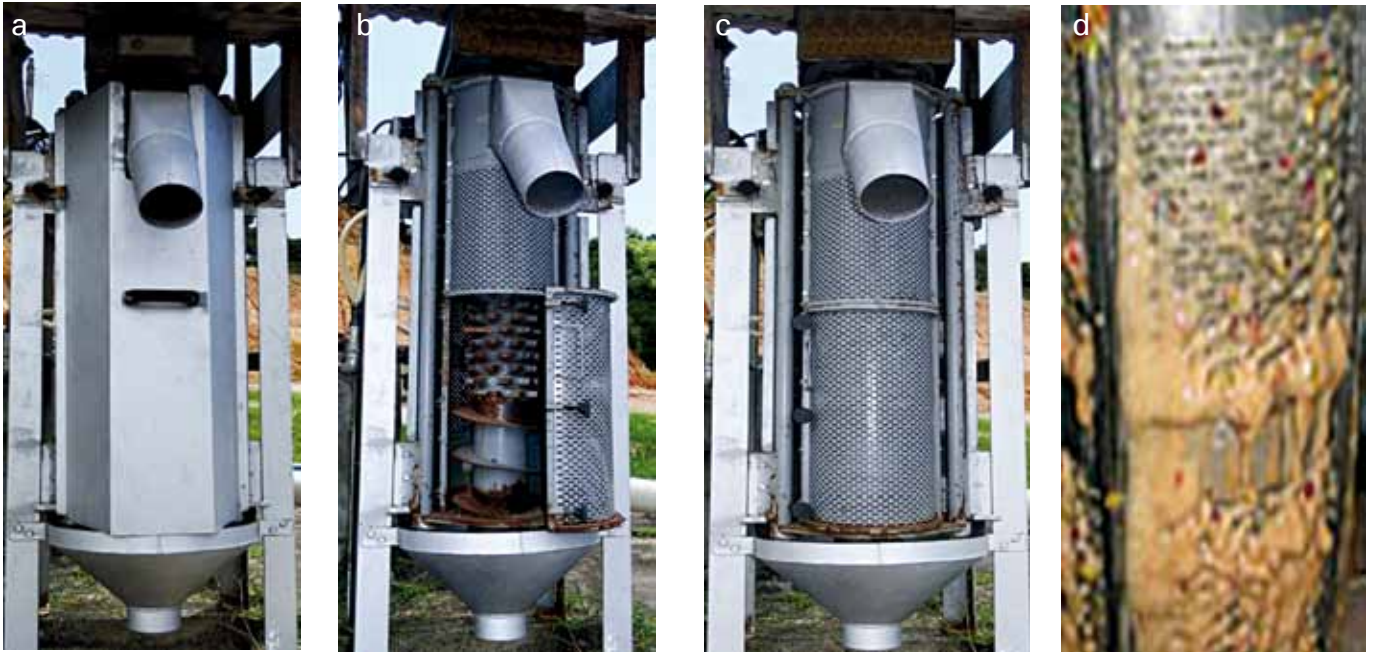
Figura 13. Desmucilagem mecânica: (a) vista geral do desmucilador, (b) detalhe cilindro e do eixo, (c) cilindro separador sem a carenagem de proteção e d) detalhes da saída da mucilagem.
