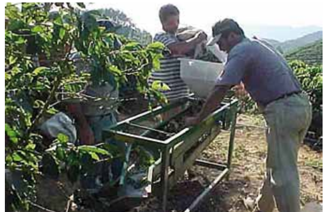
Figura 7. Limpeza e abano com abanadora portátil com acionamento manual.
