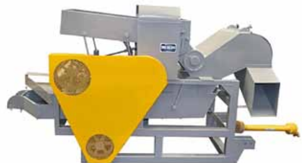
Figura 8. Máquina de pré-limpeza acionada pela tomada de força do trator.
