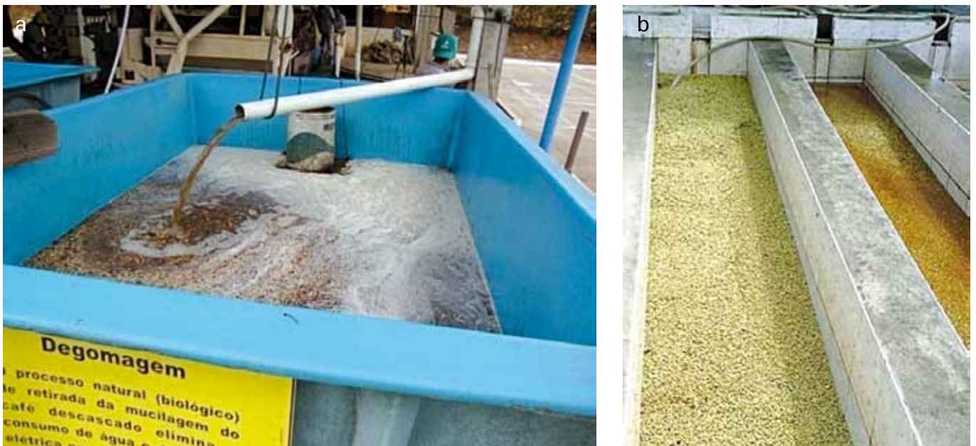
Figura 14. Desmucilagem biológica: (a) tanque de fermentação e (b) canais de lavagem.
