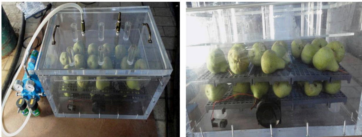
Fig. 4. Caixa de acrílico fechada, conectada a uma bomba de vácuo e provida de mini ventilador, contendo peras dispostas sobre estrado plástico modular.
