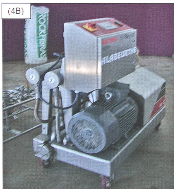
Figura 4: Foto de um pasteurizador para vinhos (Figura 4A) e da membrana de troca iônica (Figura 4B).
