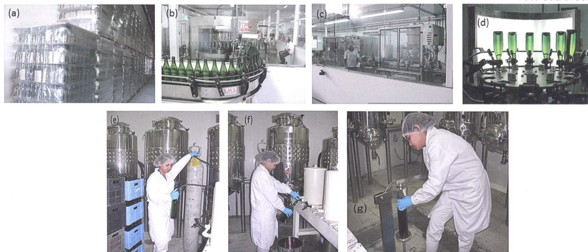
Figura 5: Figuras exemplificando etapas do engarrafamento industrial (Figuras a, b, c e d) e artesanal/ experimental (Figuras e, f e g) tomando-se as devidas medidas de controle para assegurar a elaboração de vinhos de qualidades e seguras à saúde do consumidor.
