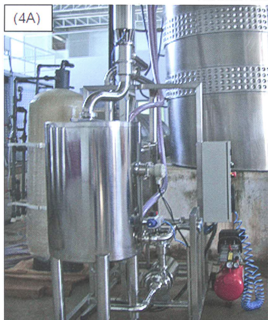
Figura 4: Foto de um pasteurizador para vinhos (Figura 4A) e da membrana de troca iônica (Figura 4B).
