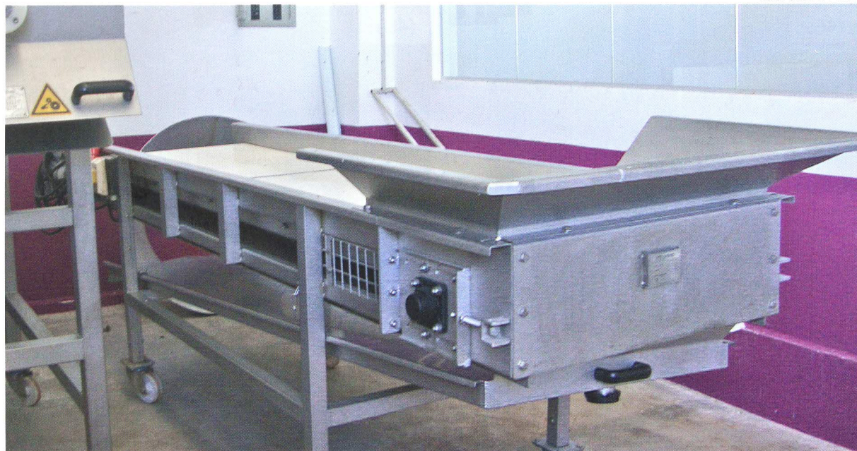
Figura 3: Foto de mesa de seleção que deve ser utilizada para a retirada de uvas danificadas antes de entrarem para a máquina desengaçadora/esmagadora.
