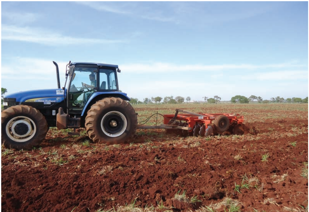
FIGURA 5.1 - Grade pesada para incorporação de calcário na área total onde será implantado o sistema de ILPF. Foto: Ademair P. Serra.
