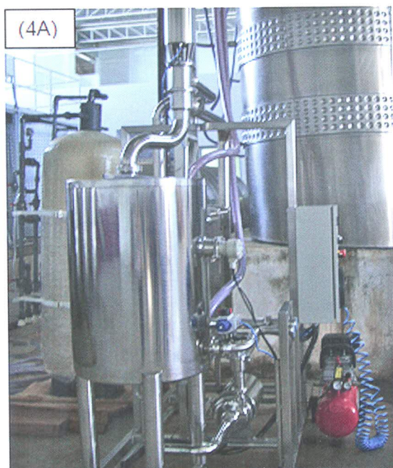
Figura 4: Foto de um pasteurizador para vinhos (Figura 4A) e da membrana de troca iônica (Figura 4B).
