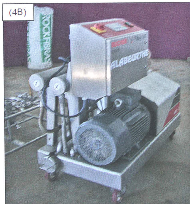
Figura 4: Foto de um pasteurizador para vinhos (Figura 4A) e da membrana de troca iônica (Figura 4B).
