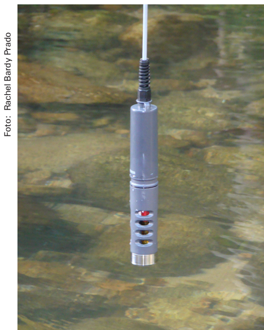
Figura 4. Monitoramento da qualidade da água in situ , utilizando medidor de qualidade da água portátil. Município de Cachoeiras de Macacu - RJ.
