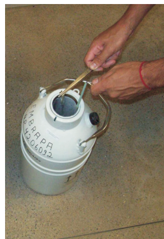
Figura 18. Congelamentos das palhetas nas raques dentro botijão de vapor de N 2 L.
