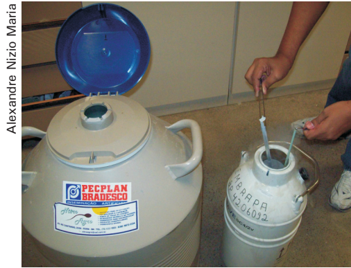
Figura 19. Transferência das raques para o botijão de N_2L .
